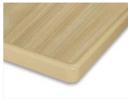
25 mm Tischplatte Eichedekor 0,8 mm HPL beschichtet mit 8 mm PUR Kante
