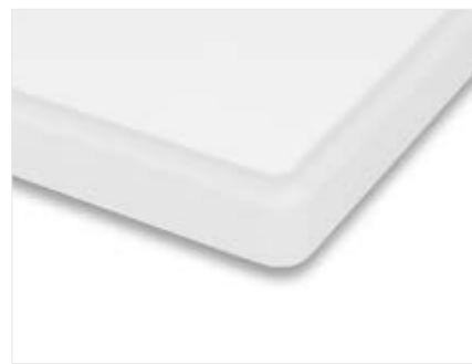
25 mm Tischplatte weißgrau 0,8 mm HPL beschichtet mit 8 mm PUR Kante
