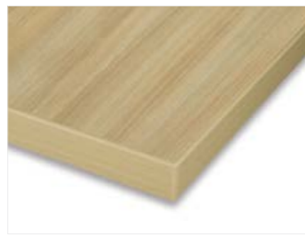
25 mm Tischplatte Eichedekor 0,8 mm HPL beschichtet mit 3 mm PP-Kante
