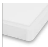
AP02-02 30 mm Arbeitsplatte 0,8 mm HPL beschichtet Weißgrau, 8 mm PUR Kante Lichtgrau
