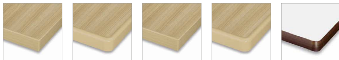
AP01-05 25 mm Arbeitsplatte melaminharz-beschichtet Eiche, 3 mm PP-Kante Eiche AP01-06 25 mm Arbeitsplatte melaminharz-beschichtet Eiche, 8 mm PUR-Kante beige AP01-07 25 mm Arbeitsplatte 0,8 mm HPL-beschichtet Eiche, 3 mm PP-Kante Eiche AP01-08 25 mm Arbeitsplatte 0,8 mm HPL-beschichtet Eiche, 8 mm PUR-Kante beige AP01-09 10 mm Arbeitsplatte Vollkern weiß, Kante gerundet schwarz
