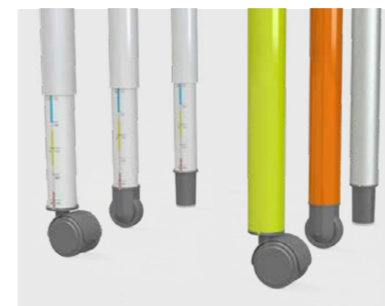
Modulares Fußkonzept (Lenkrolle, Bockrolle, TPE Gleiter) mit oder ohne Höhenverstellung (in 30 mm Rastern).
